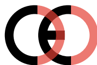
Faux marquage CE (trop proche)
